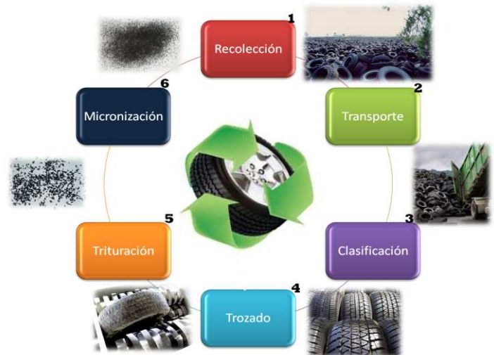
Figura 3. Proceso de reciclado de llantas denominado 'trituración'.
